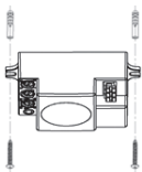
Рис. 8 - Монтаж датчика MW-706
