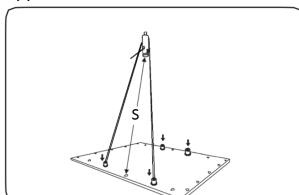
5.6. Прикрутити кабель підвісу до стельового фіксатора.
