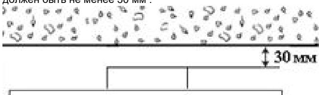
4. Не накрывать светильник теплоизолирующим материалом.
