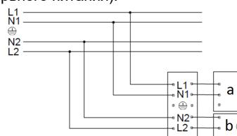
3. Схема подключения светильника к питающей сети с регулируемым драйвером по системе DALI .
