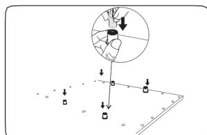
5.5. Відрегулювати довжину кабелю підвісу до потрібної довжини (де  $S$  - відстань). Для світильника розміром 595x595 відстань - 350 мм.
