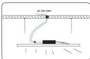
6. ВНИМАНИЕ: светильник смонтированный на тросовые подвесы в процессе эксплуатации может выгибаться относительно плоскости подвеса до 5мм, что не является браком и не влияет на работоспособность и характеристики изделия!
