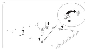
5.3. Пригвинтити кріплення підвісу до панелі світлодіодів.
