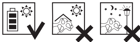
Рис. 4. Условия размещения гирлянды
