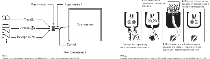
Рис.2. Схема подключения светильника SPO-6-36 (без коннектора для БАП) к сети 220В.
