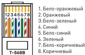
Рис. 6. Схема обжима проводников в соответствие с TIA 568B
